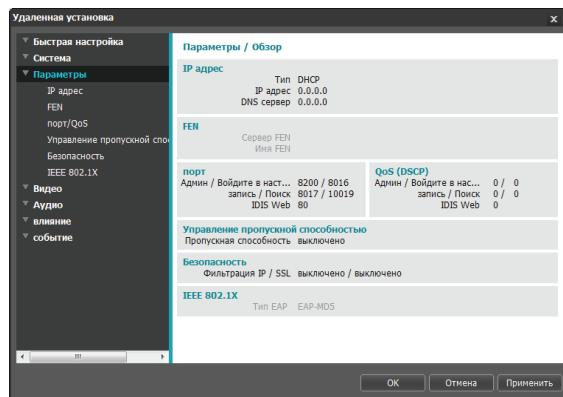
Изменяет сетевые настройки, подключает FEN и защитные функции, регулирует использование пропускной способности сети.
