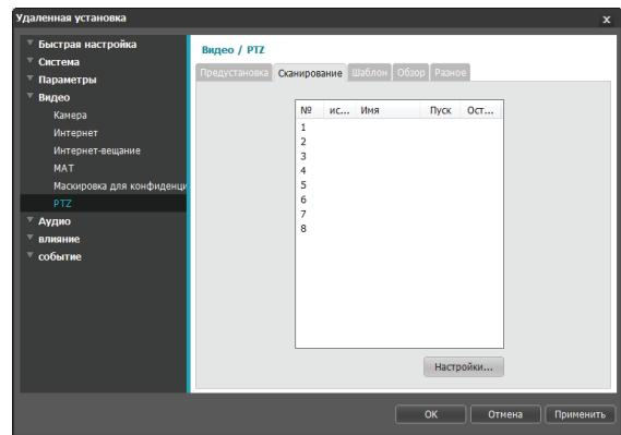
Показывает список сканирования. Число указывает номер сканирования. Нажмите кнопку **Настройки**, чтобы настроить параметры сканирования.
